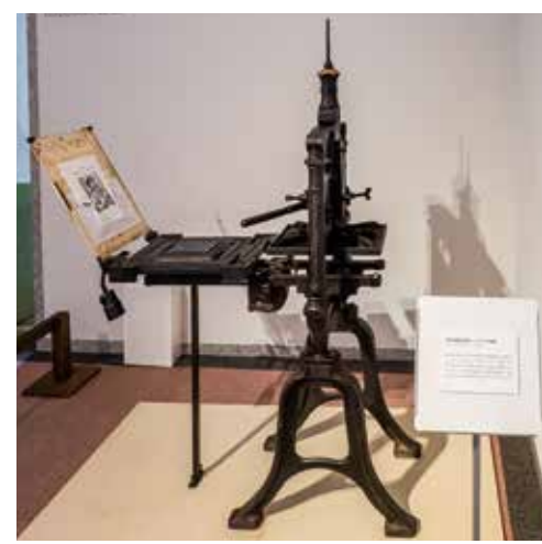
会場入り口に展示されている印刷機は、築地活版製造所が製造した、手でハンドルを引いて印刷するハンドプレス機(ミズノプリンティングミュージアム所蔵)。
