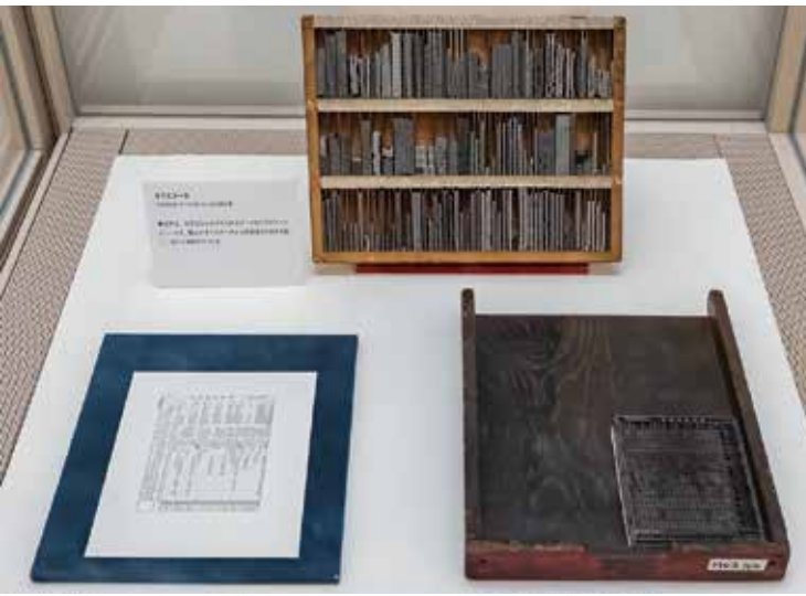
活版印刷の工程を写真(精興社所蔵)で紹介。左から活字鑄造(活字の元となる母型を活字鑄造機にセットし、鉛などの合金を溶かしたものを流し込んで活字を鑄造する)→文選(印刷に使う活字を原稿の通りに集めて並べる作業)→植字(選んだ活字を組んで版を作る作業)→組版を作る→校正刷り→紙型の製作→鉛版の製作→面付け→印刷。
