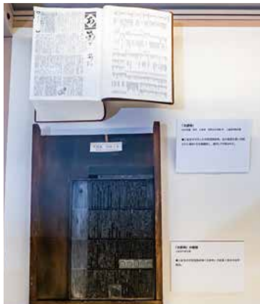
三省堂の中型国語辞典『大辞林』の活字組版(三省堂印刷所蔵)。組版とは、活字を原稿通りに組んだ印刷原版のこと。
